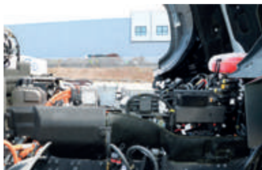
La unidad de tracción compuesta por tres motores eléctricos está ubicada en posición delantera longitudinal, similar a la de los motores térmicos.
