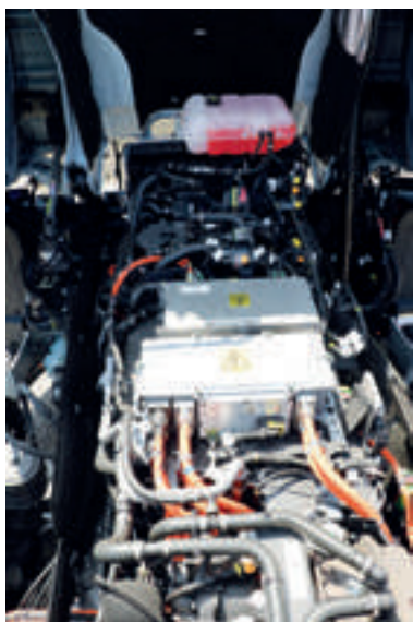
La unidad de tracción compuesta por tres motores eléctricos está ubicada en posición delantera longitudinal, similar a la de los motores térmicos.
