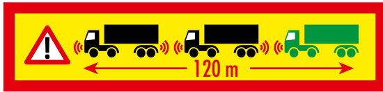
■ Ejemplo de la pantalla trasera electrónica en el último vehículo de un platooning.
