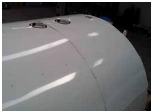
Válvulas de sobrepresión de cisterna de GLP
