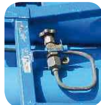
VÁLVULA DE CARGA Y DESCARGA DEL BLOQUE
