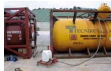
Conexiones con válvula para bombeo. Colocación válvula de seccionamiento. Circuito cerrado de bombeo
