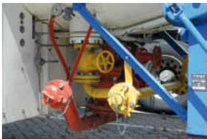
Conducciones de fase líquida (roja) y fase gas (amarilla)
