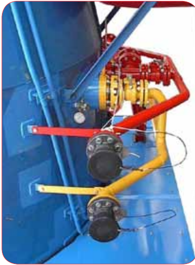
CONEXIONES CARGA / DESCARGA Y VALVULAS DE FONDO
