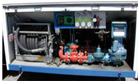
Bomba de trasiego, caudalímetro y manguera de suministro
