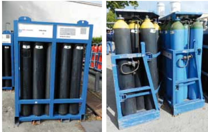
Bloques: conjuntos de 16 botellas B50 inter-conexionadas entre sí mediante un colector y terminando en una válvula de descarga.
