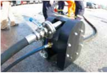
Bombas de membrana de accionamiento neumático (mediante compresor)
