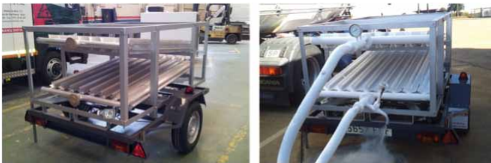
Fig. 17. Trasvase con ayuda de un PPR portátil. A la izquierda, antes de la operación. A la derecha, durante el trasvase. (Fotos cortesía de ESK)
