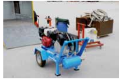
Bombas de membrana de accionamiento neumático (mediante compresor)
