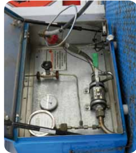
VÁLVULA DE CARGA/DESCARGA CON VÁLVULA DE PURGA
