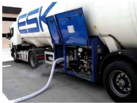
Fig.11. Colocación del mangote de 3" de la fase líquida de ambas cisternas. (Foto cortesía de ESK)
