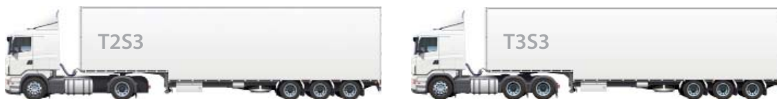
Figura 1. Configuración de ejes de los vehículos pesados T2S3 y T3S3.
