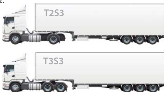
Figura 2: Configuración de ejes de los vehículos pesados T2S3 y T3S3.
